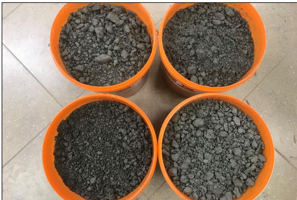
Obrázek 6: Část vzorku recyklované směsi HGT před kvartací (foto J. Havelka, 2020)
