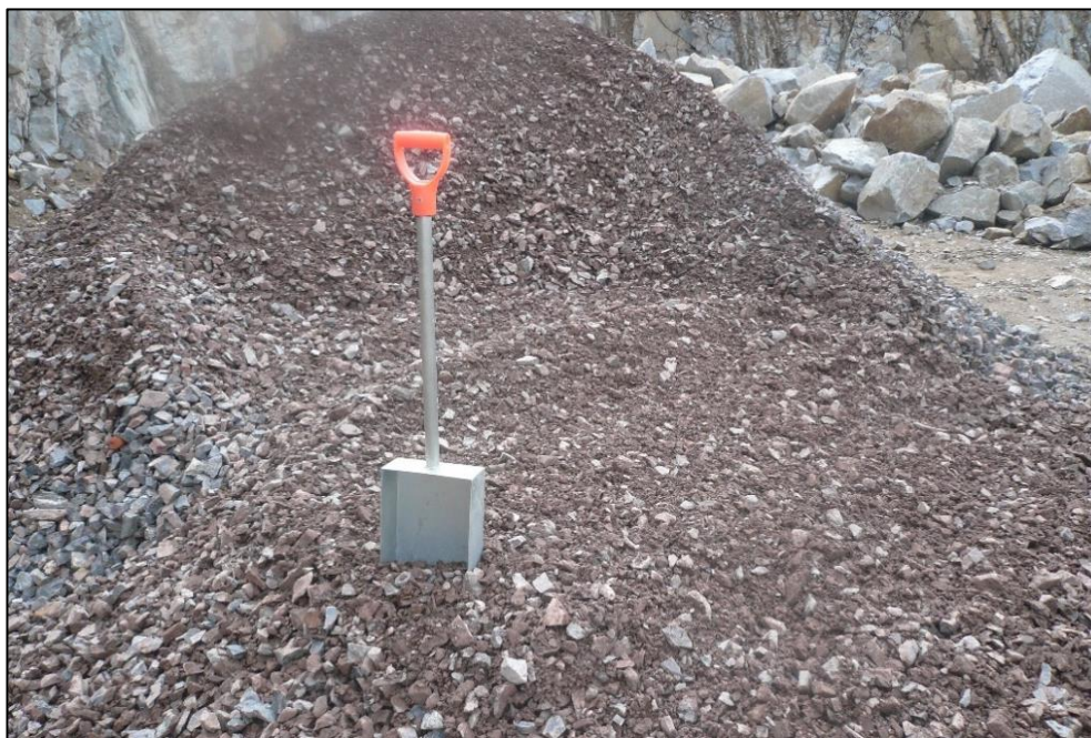
Obrázek 3: Směs kameniva 0/63 vyrobená jednostupňovým drcením hlušiny (foto J. Havelka, 2020)
