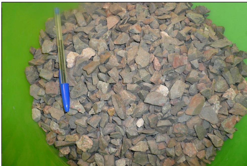
Obrázek 5: Separovaný vzorek 8/16 pro přípravu zkušební frakce 10/14 ke stanovení odolnosti proti drcení
