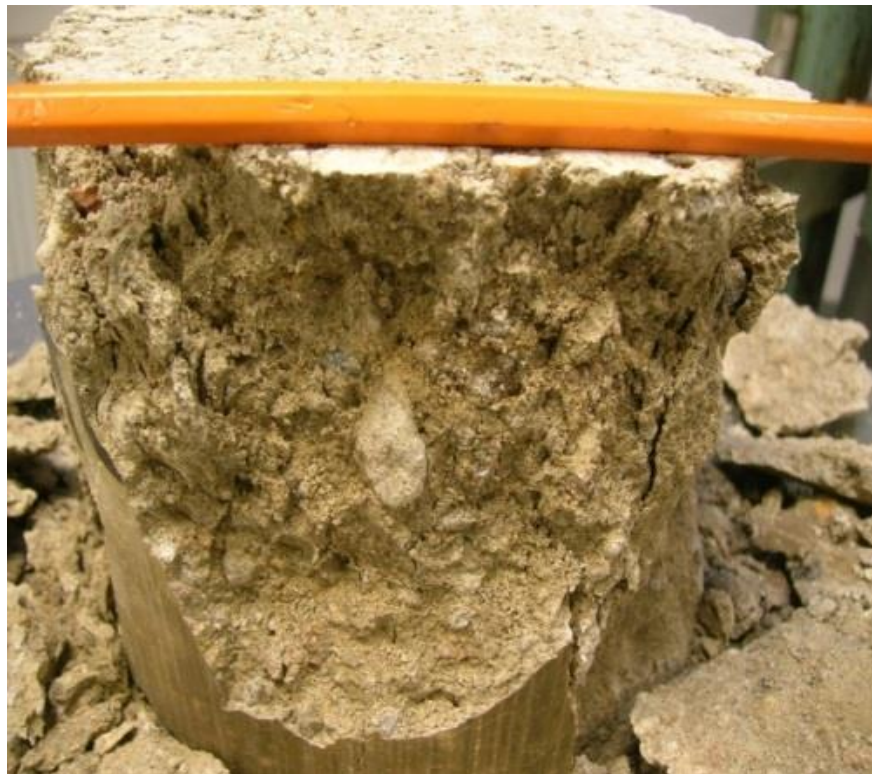
Ukázka zkušebního vzorku po zkoušce – dávkování 16% cementu
